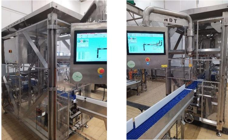
*Fortschrittliches Ultraschall-Schneidsystem mit Servozylindern und Servomotoren für extreme Genauigkeit, Geschwindigkeit und flexible Funktionen.*
